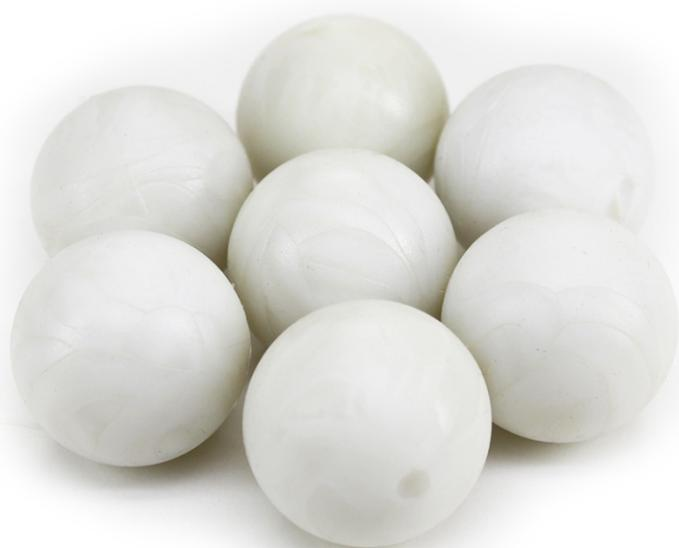
As Esferas de Borrachas são utilizadas nos quadros das peneiras de máquinas de pré-limpeza e classificação de grãos para melhorar o desempenho e reduzir o entupimento dos orifícios da peneira.
